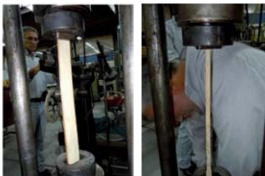
Ficha de los ensayos sobre las probetas de bambú e imágenes del proceso. 4
