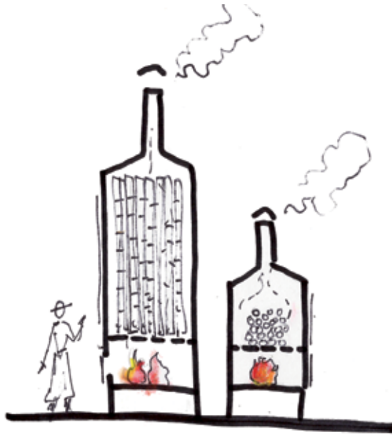
Secado a fuego directo con los culmos en posición vertical y horizontal.
