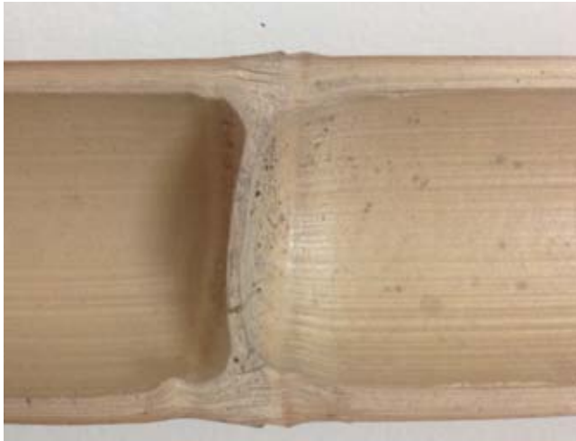
Parte interna de la caña, donde se observa el nudo con el diafragma, el área más resistente.
