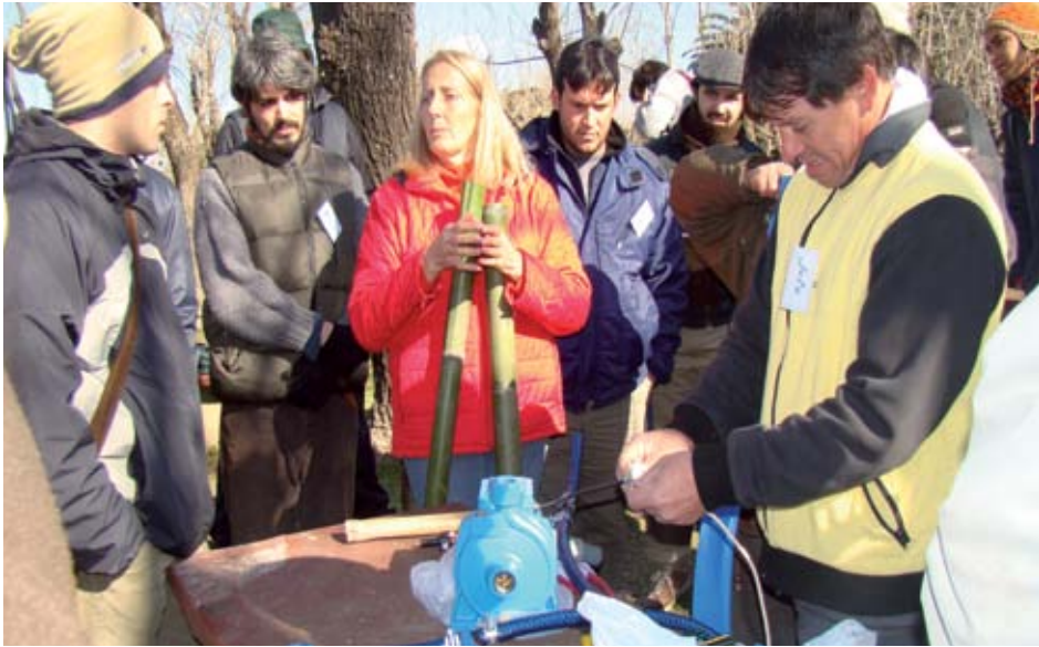
Armado del método Boucherie modificado. Ayudante: Julio Silva.
