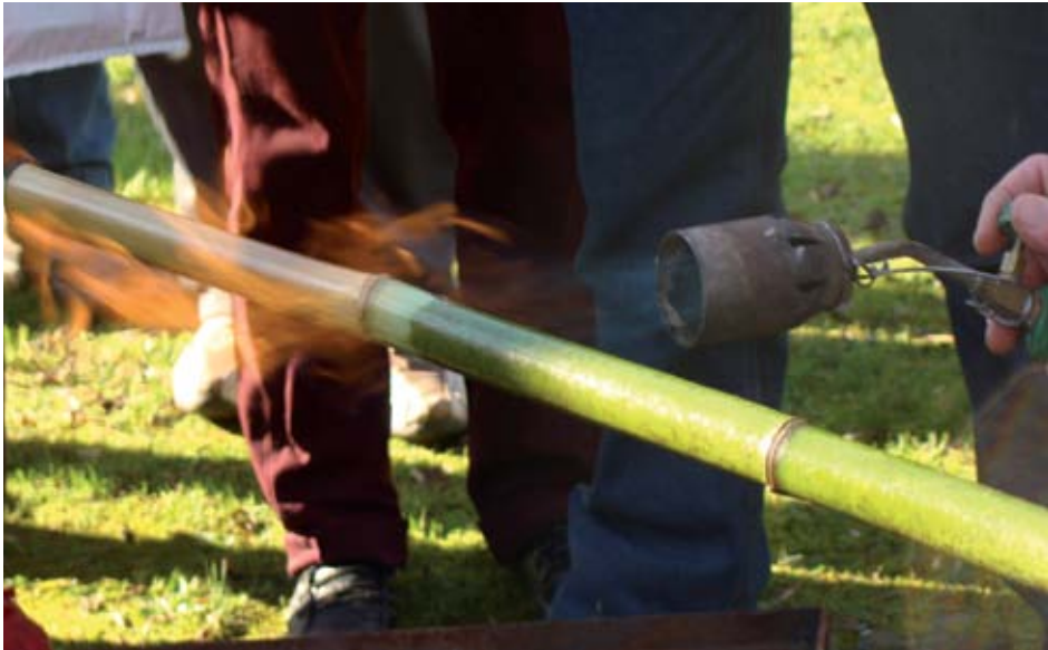
Curado con soplete (se observa cómo la caña pierde sus ceras exteriores).
