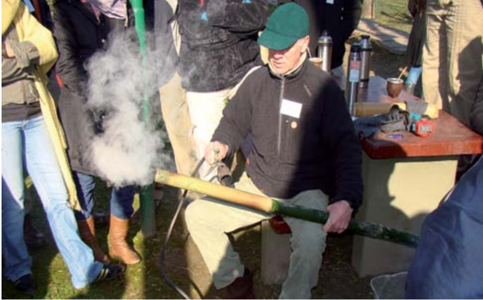
Curado con soplete (se observa el cambio del color verde a marrón)
