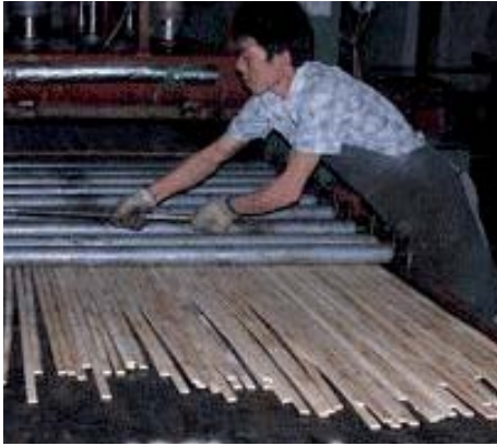
7) Encolado con material adhesivo
